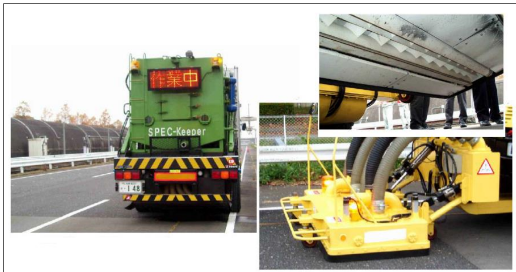
Rysunek 4 Sprzęt wykorzystywany przy czyszczeniu nawierzchni z asfaltu porowatego (Źródło: Zastosowanie nowoczesnych technologii w konstrukcjach drogowych, Zakopane 15–17.09.2010 r.)
