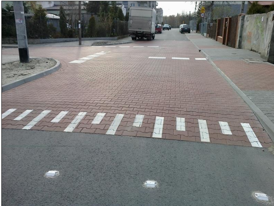
Rysunek 1 Przykład wyniesionego skrzyżowania (Źródło: zm.org.pl)
